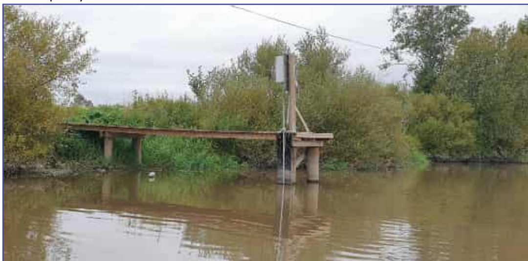
Kuva 10. Jatkuvatoinen veden laadun mittauspiste Myllykulmankosken yläpuolella Lahden ja Orimattilan välisellä jokiosuudella.
