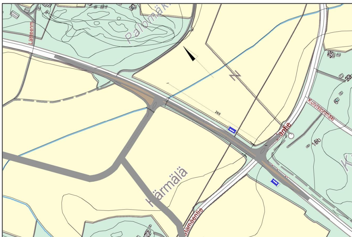
Kuva 7. Pennalantie - Rautamäentie-liittymän porrastus ja kääntyvät kaistat.
