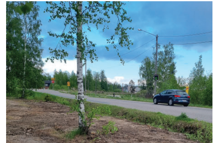
Kuva. Ajonopeuden 1. mittauspiste keväällä 2023. Laite rekisteröi ajonopeudet molemmista suunnista, vaikka näyttötaulu oli vain toiseen suuntaan.
