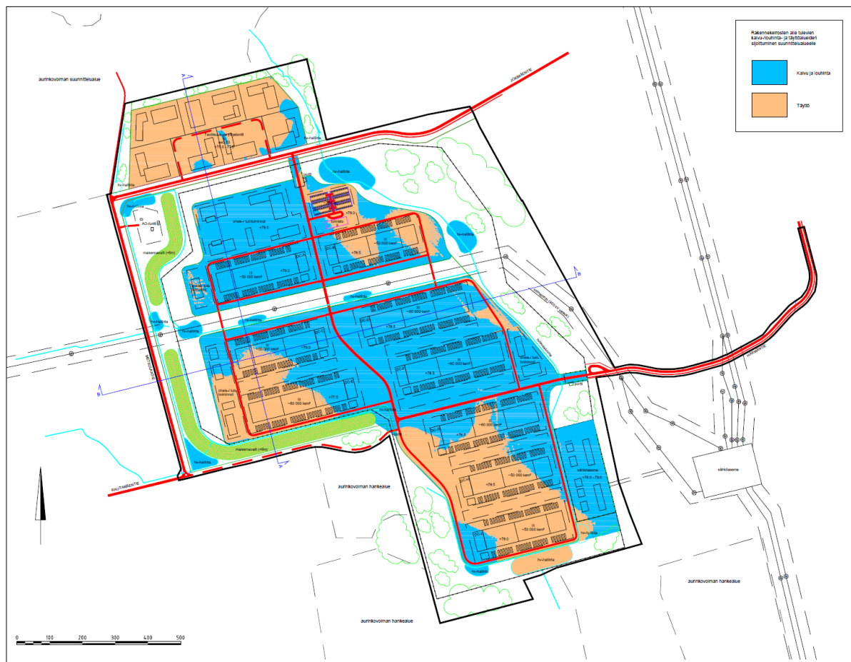
Kuva 8-3. Rakennekerrosten alle tulevien kaivu-/louhinta- ja täyttöalueiden sijoittuminen suunnittelualueelle.
