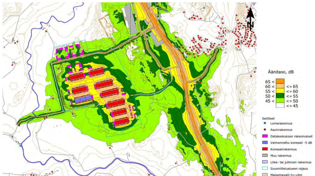
Kuva 8-19. Ote meluselvityksen mallinnuksesta, jossa datakeskuksen päiväajan keskiäänitaso sekä tieliikenteen melu.
