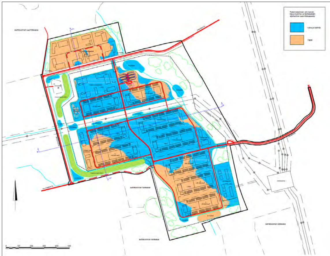
Kuva 8-7. Rakennekerrosten alle tulevien kaivu-/louhinta- ja täyttöalueiden sijoittuminen suunnittelualueelle.
